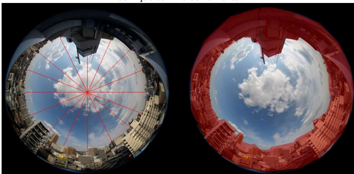
Figura 25: Esquema de visada 360° do hemispherical viewshed (fisheye) para definição da linha do horizonte.
